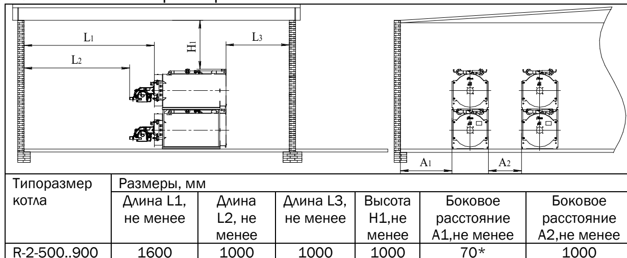
Рисунок 9. Установочные размеры
