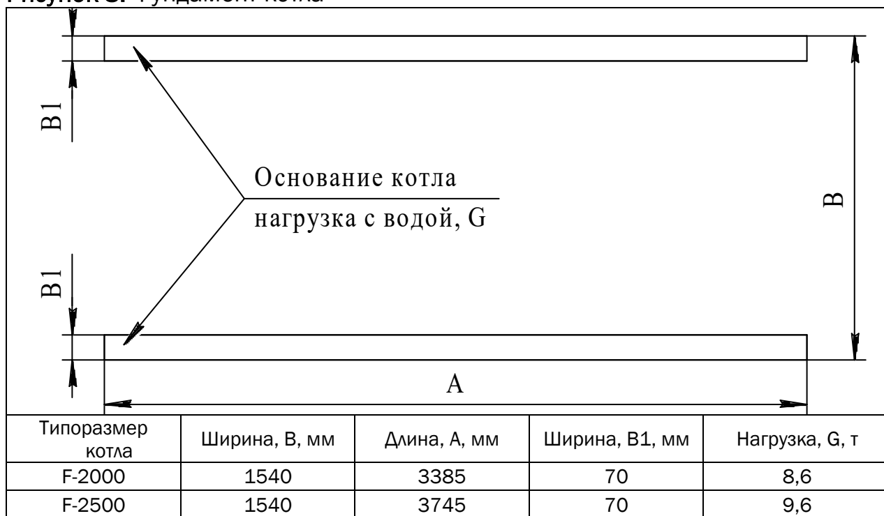
Рисунок 8. Фундамент котла
