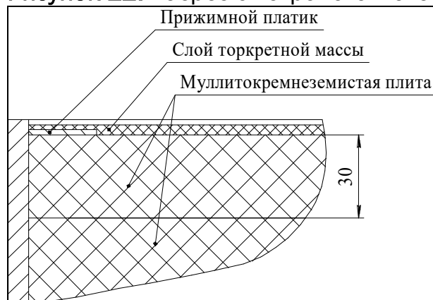
Рисунок 12. Разрез смотрового люка
