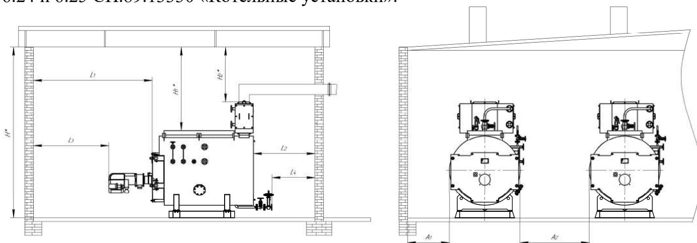
Рисунок 19. Размеры для размещения котла в котельной.
