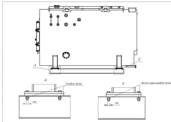
Рисунок 17. Защита от теплового расширения.
