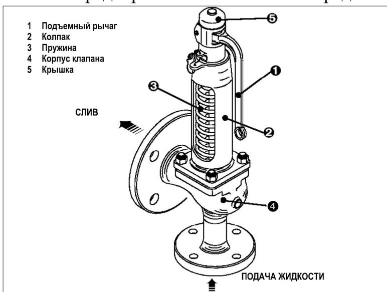
Рис. 4 Клапан предохранительный
