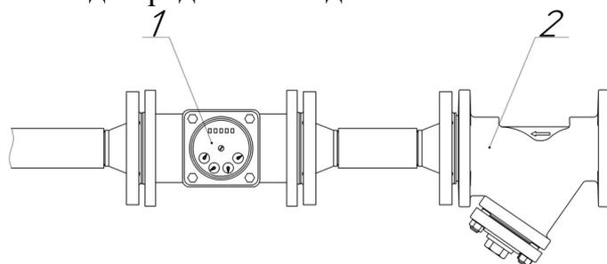
1.Счетчик расхода воды Ду40, 2. Фильтр воды Ду40.
