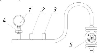
1.Манометр. 2. Датчик давления системы управления горелки, 3.Реле максимального давления, 4. Игольчатый клапан, 5. Вентиль запорный Ду20.
