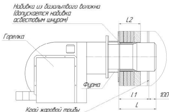
Рис. 15. Крепление горелки
