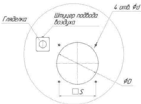
Рис. 14. Отверстие под горелку
