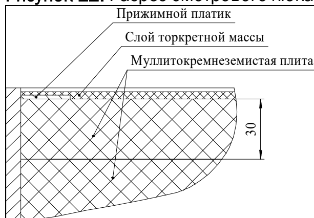
Рисунок 12. Разрез смотрового люка
