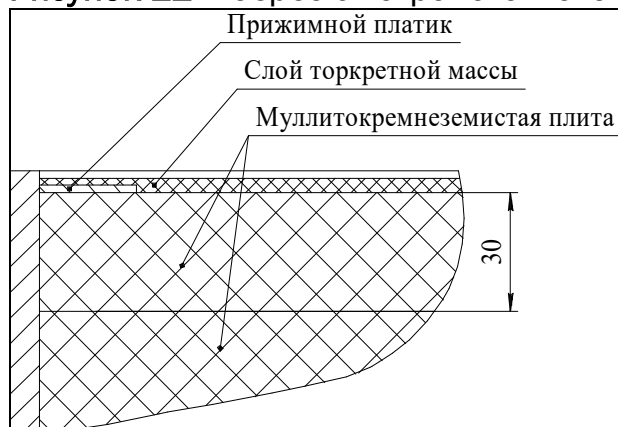
Рисунок 12. Разрез смотрового люка
