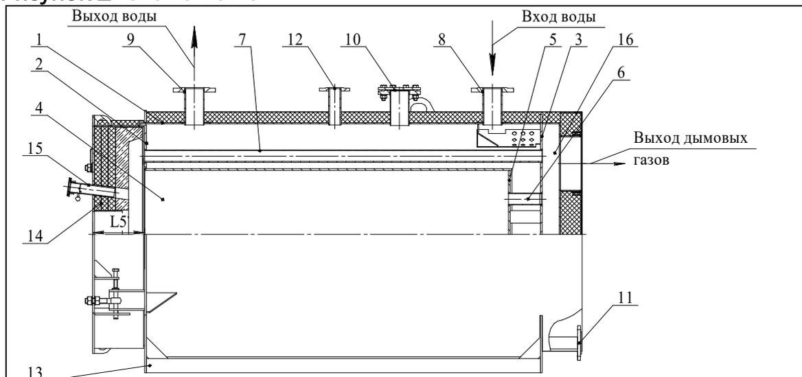
**Рисунок 3. Отверстие под горелку**
