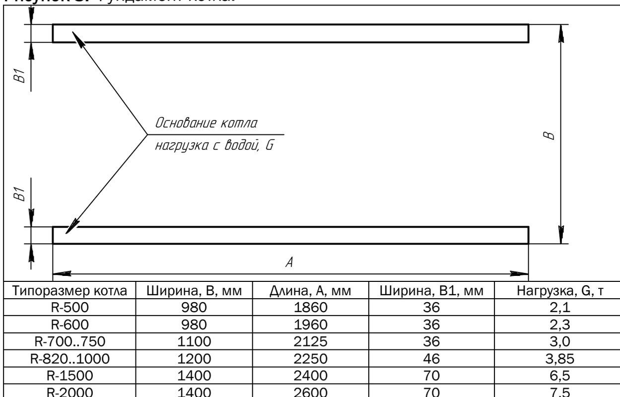
При обнаружении уклона под опоры котла допускается подкладывать тонкие стальные пластинки до тех пор, пока не будет достигнута требуемая горизонтальность. Прямолинейные поверхности котла необходимо контролировать на горизонтальность в направлении длины и ширины. После установки котла жестко зафиксировать его к основанию.
