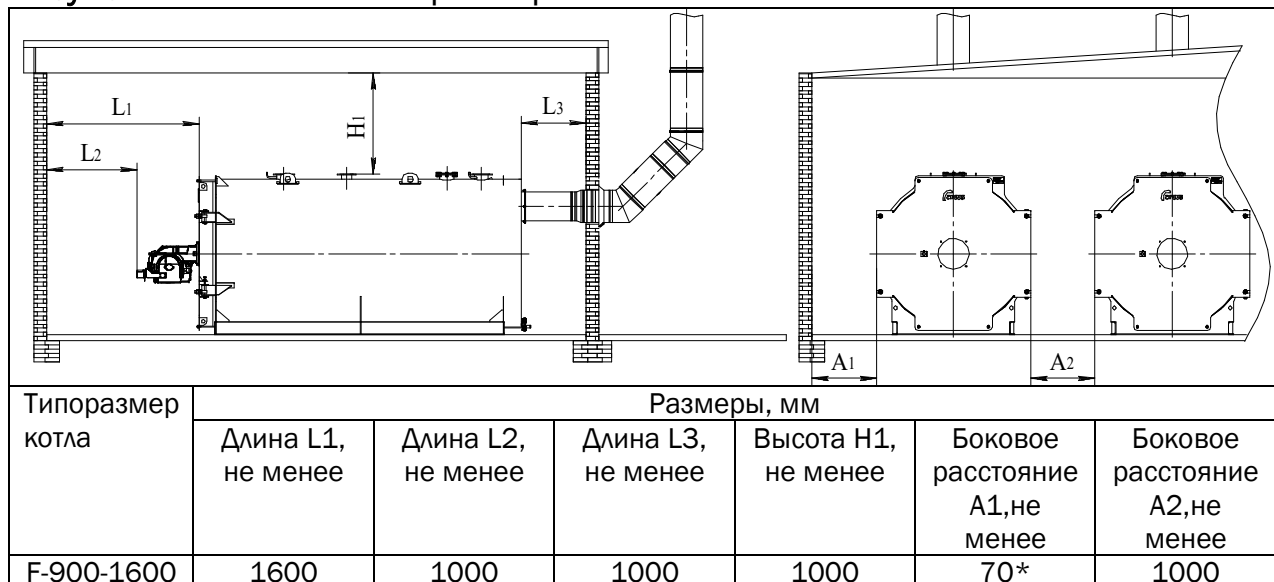
Рисунок 7. Установочные размеры
