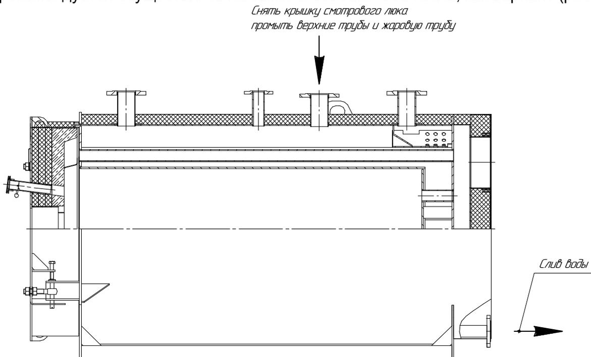
Рисунок 9. Варианты промывки модуля котла.
