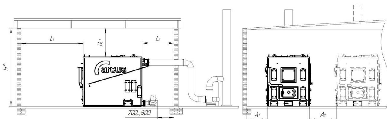
Размеры помещения котельной и установочные размеры отопительных котлов КВм-К
