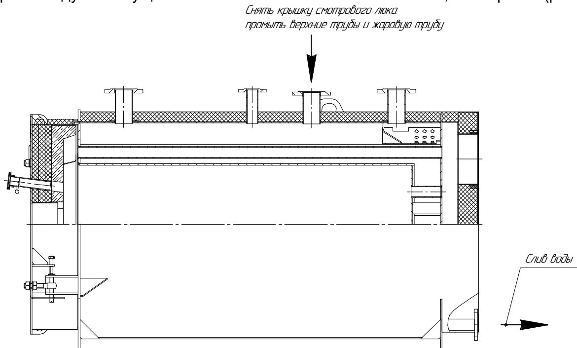
Рисунок 9. Варианты промывки модуля котла.
